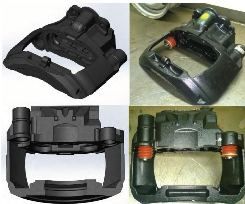
Рис. 1. 3D модель тормозного механизма, выполненная в среде Solidworks, и её прототип
