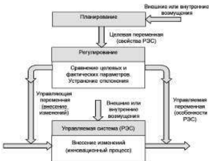
Рис. 2. Контур управления инженерными изменениями в РЭС
