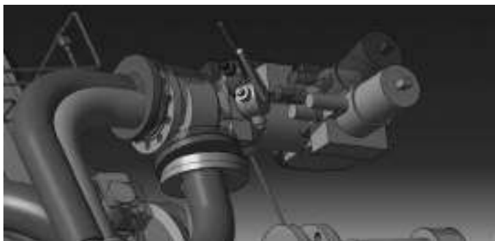
Рис. 5. Совмещение теоретической модели ( синяя ) и модели, полученной по результатам реверсного проектирования ( желтая )
